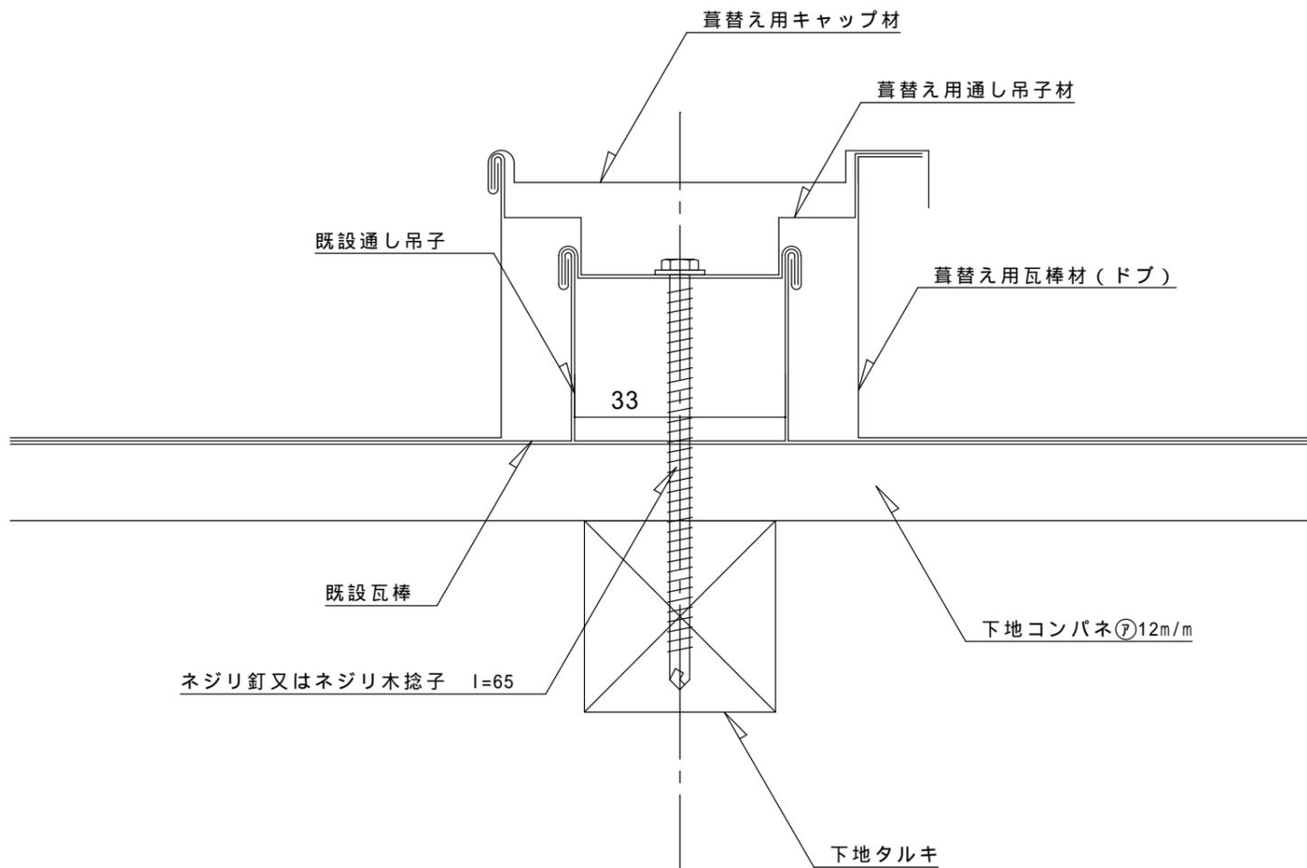
葺替え用瓦棒軒先断面図 1/3
