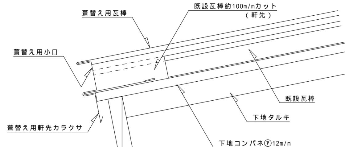
葺替え用瓦棒 寸法図 1/2
